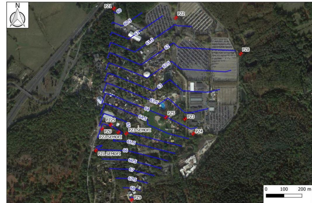
Figure 23 : Carte piézométrique approximative des basses eaux au droit de la zone d'étude à partir des mesures de 2023 (GEOTECHNIQUE APPLIQUEE)
